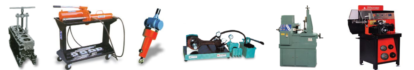
Vam tháo lắp sơ mi xylanh Máy ra xupáp khí nén TB kiểm tra và kéo nắn tay biên TB doa lỗ tay biên Máy tiện láng đĩa phanh trên xe
